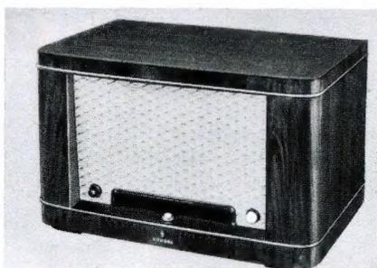
UKW-Empfänger von Siemens für Feuerwehr- und Grubenrettungs-Alarmnetze. Links ist die Signallampe für „gespeicherten Ruf“ zu erkennen
